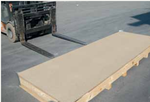
fig.3 / Для подъема и перемещения поддонов с плитами формата 1000x3000 мм или Full Size с помощью автопогрузчиков или подъемных кранов, необходимо ухватить тару с длинной стороны, встав на уровне ее центра и максимально разведя вилы, которые должны захватить паллету по всей ее ширине
